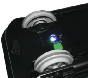
Die Lokomotive wird über den kleinen, grünen Schalter an der Unterseite ein- und ausgeschaltet. Das Kontrolllicht leuchtet nach dem Einschalten und beleuchtet die Schienen zur besseren Erkennung der Farbe der Codesteine. Nach dem Einschalten die Lokomotive einfach auf die Schiene setzen, anschieben oder über mit der App verbinden und damit steuern.
