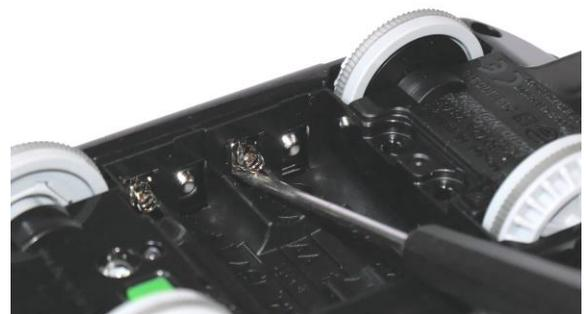
Zweites Manko sind die Antriebsräder. Diese sind mit einer Rutschkupplung versehen, welche die Räder vom restlichen Getriebe entkoppeln, um Schäden beim zu heftigen Anschieben zu vermeiden. Leider ist der Mechanismus nicht sehr stabil und kann sich so stark abnutzen, dass die Räder durchdrehen. Nach dieser schlechten Nachricht folgt sogleich die ganz schlechte Nachricht: es gibt keine Ersatzteile für derart abgenutzte Räder.
